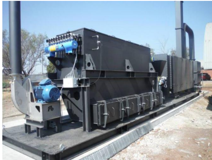
Figura 6. Ilustración de Horno pirolítico Incinerador 8-1000, dimensionado para tratar hasta 1 t/hora de RSU.
